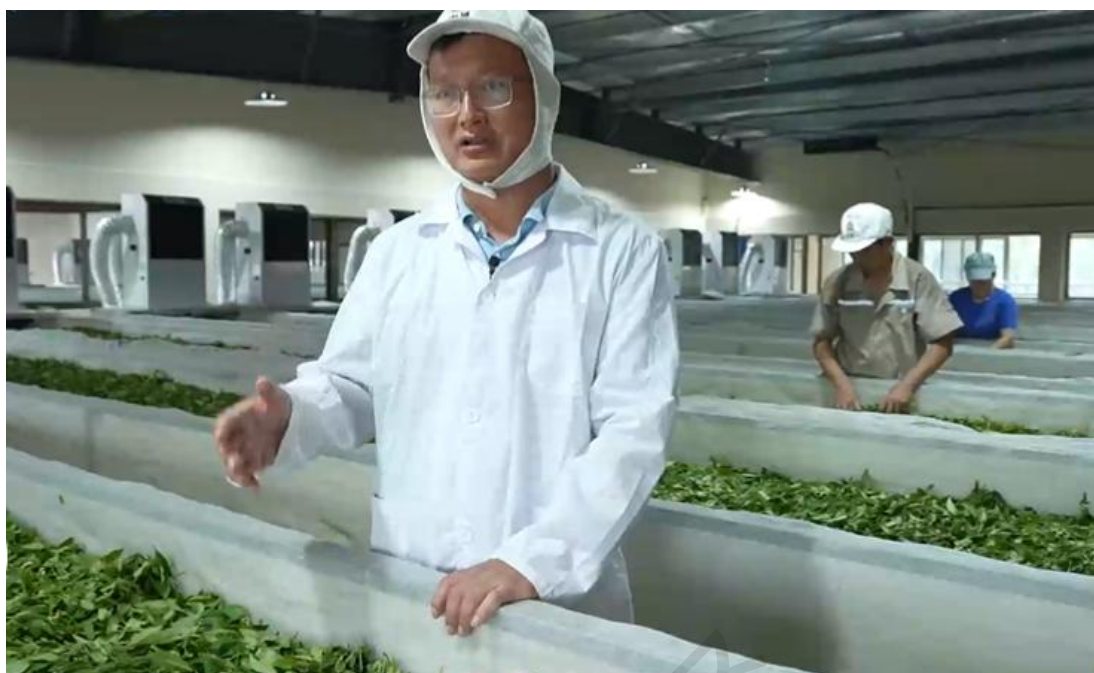
叶红与创新研发的白茶新型自动化萎凋槽 第一财经拍摄
