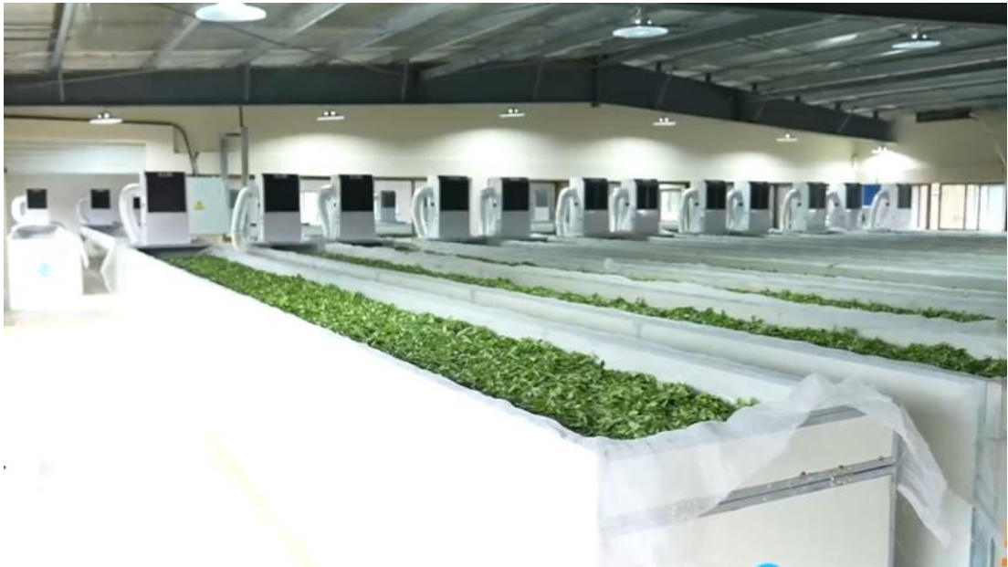
叶红与创新研发的白茶新型自动化萎凋槽 第一财经拍摄
